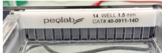
Abbildung 6: Kamm für das Agarose Gel (eigene Aufnahme)
