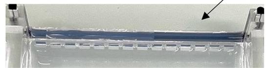
Abbildung 7: Durch Kamm entstandenen Taschen im Agarose Gel (eigene Aufnahme)
